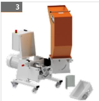
Rotor und Siebaufnahme sind vollständig zugänglich und frei einsehbar. Das Sieb lässt sich mit einem Handgriff entnehmen. Hinterschneidungen, in denen sich Material sammelt, sind auf ein Minimum reduziert. Die Reinigung der Mühle ist schnell und einfach zu erledigen.
