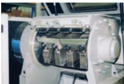
▲ De massieve maalruimte met rotor in V-snede is goed toegankelijk.
