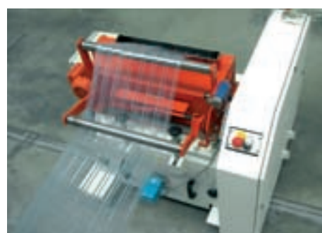
Maalmolen D25.50 met een rolintrek, voor het verwerken van foliebanden en randstrips.
