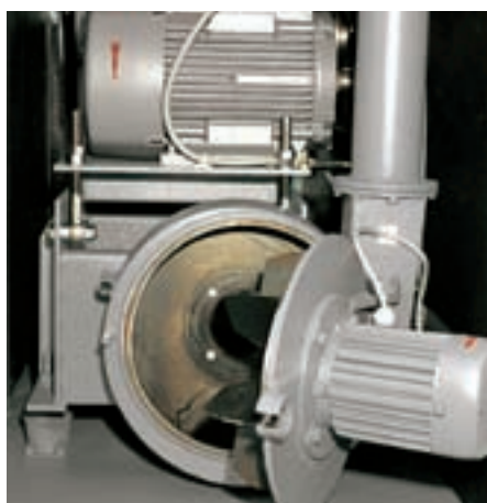
▲ Optioneel kan een ventilator in de geluidswerende behuizing ingebouwd worden.
