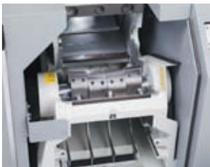
◀ Cámara de molienda accesible fácilmente sin necesidad del uso de herramientas.
