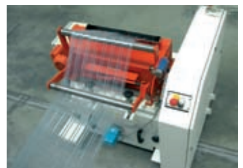
▲ Molino granulador D25.50 con sistema de alimentación por rodillos para el procesamiento de láminas continuas o tiras de rebordes.
